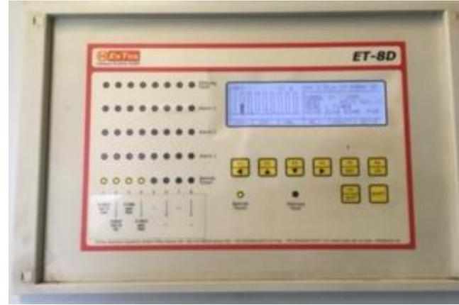
Das Gasanalysegerät dient der Analyse des Biogases. **Es misst den Gehalt der Biogasbestandteile.**
